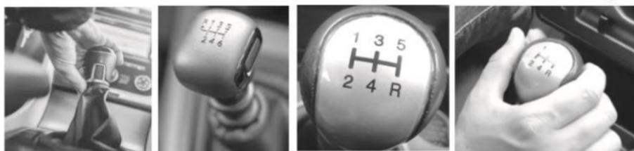
Veículo com câmbio manual tem alavanca com manopla. Nela está o desenho das marchas. Existe um modo de segurar e acionar a alavanca.
