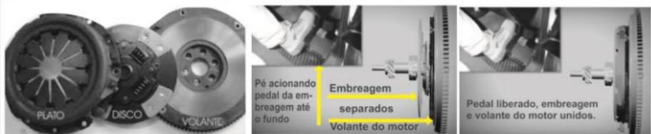
Ao acionar o pedal da embreagem, o disco do platô e o volante do motor se separam por instantes para possibilitar a troca da marcha.
